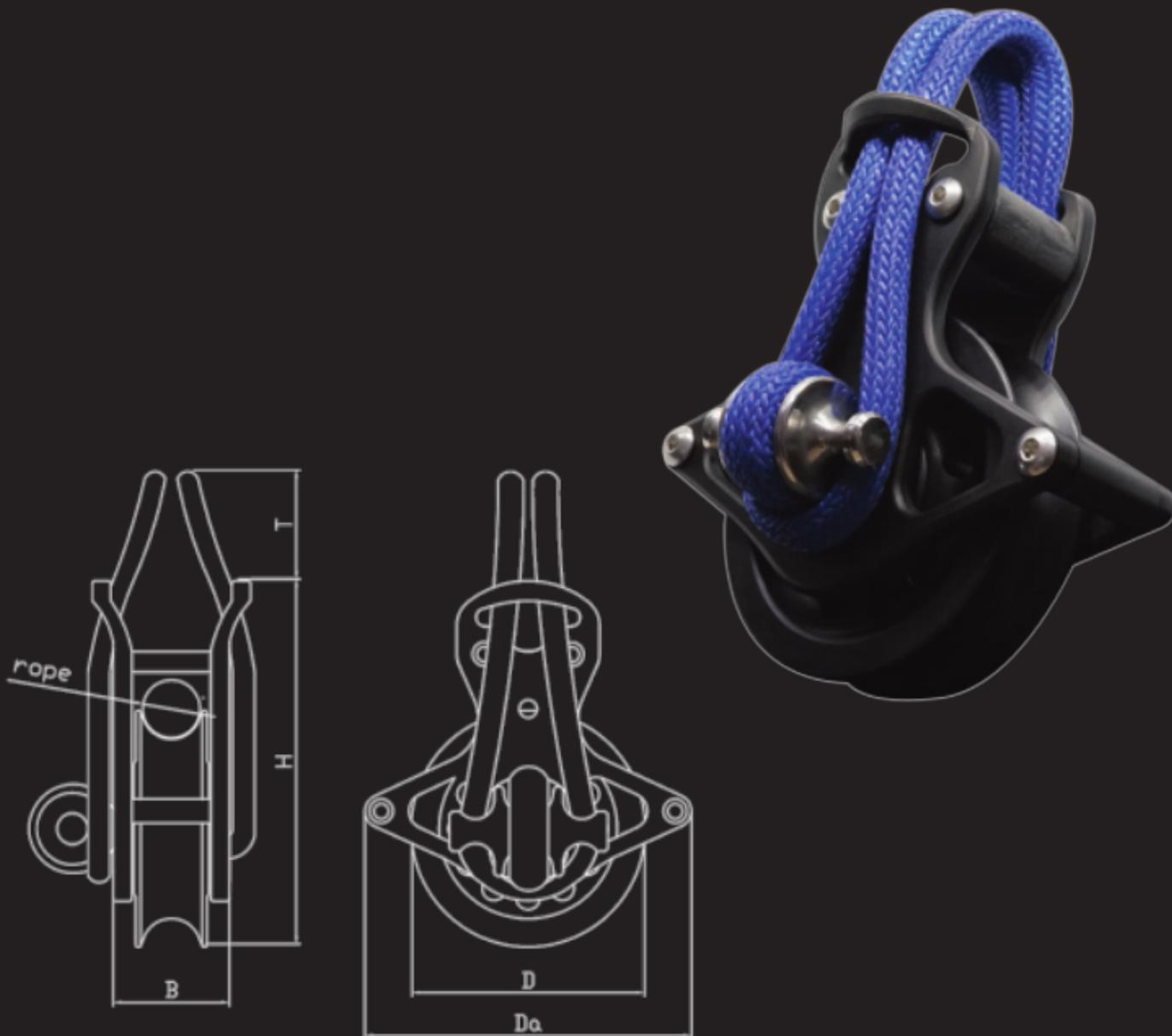
Unsere UD Blöcke („UD“ für upside down) werden meist am Segelkopf für 1:2 Falluntersetzungen benutzt. Durch die Führung der Falleine über einen großen Teil des Umfangs, wird ein Abspringen der Leine von der Seilscheibe mit daraus häufig resultierenden Folgeschäden weitgehend vermieden. Die Blöcke werden darüber hinaus auch als Backstagblöcke benutzt.
